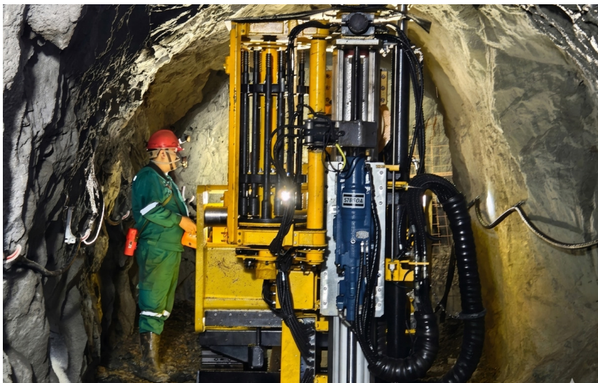
陕西诚信实业有限公司引进的全液压中深孔采矿台车
