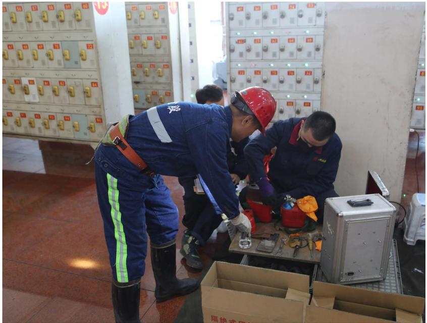
4. 对用于更换的二氧化碳吸收剂进行化验。存在二氧化碳吸收率低于35%、粉尘率高于2%、水分不能保持在16%-20%情形之一的，严禁投入使用。
